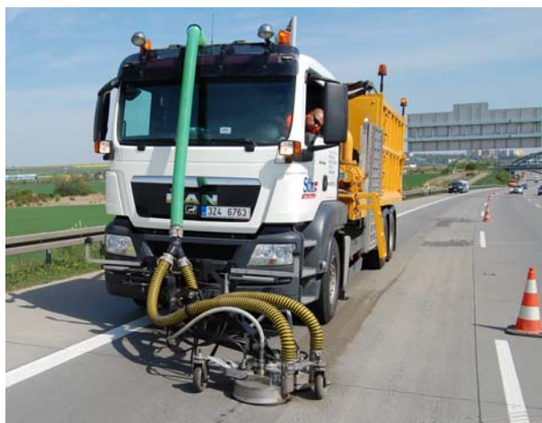
Příklad zapojení sestavy dvou trysek
