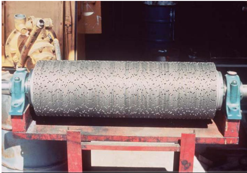
Řezné kotouče na horizontální hřídeli
